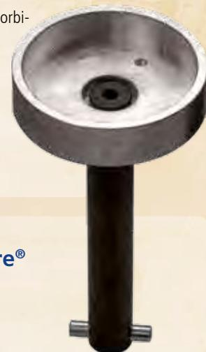
**Fuso per mastice BenchMate Encore® senza mastice per incastonatori**
