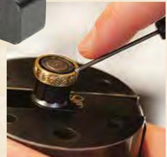
Pinza innovativa che garantisce la massima libertà durante l'incisione della parte esterna o del bordo di un anello. Questa pinza può essere fissata con diverse angolazioni in una morsa a vite. Le viti di regolazione facilitano il fissaggio della pinza nella morsa oppure possono essere eliminate per garantire una libertà di movimento ancora maggiore.
