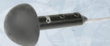
Questo bulino GRS speciale, realizzato in carburo di tungsteno, è lo strumento ideale per l'incisione a mano, soprattutto per la calcografia. Il materiale GRS C-Max utilizzato garantisce taglienti affilati che durano incredibilmente a lungo. Questi bulini in durissimo carburo di tungsteno possono essere affilati esclusivamente con una mola diamantata. Il bulino è formato da un grezzo tondo con diametro da 3,17 mm e lungo circa 75 mm.
