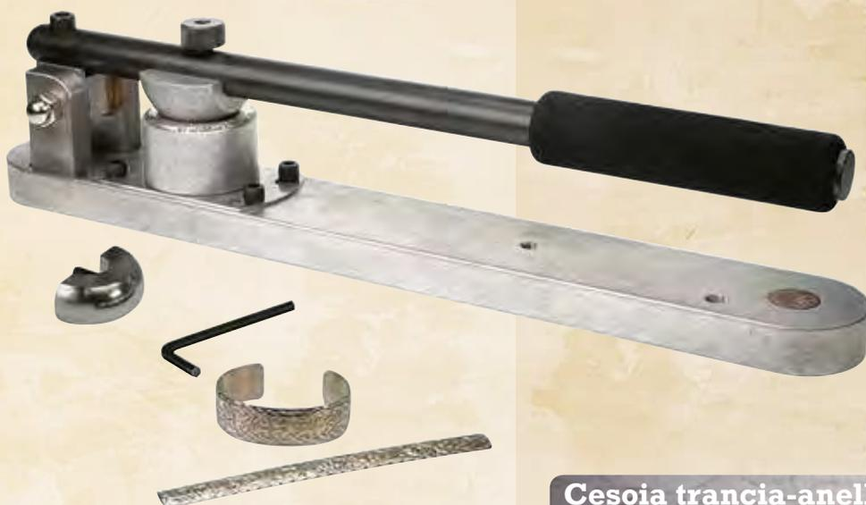
Con la piegatrice GRS, creare braccialetti con profilo a C è semplicissimo, perché vi permette di piegare i vostri nastri metallici in un perfetto profilo a C dopo aver inciso il vostro motivo. Il cilindro di appoggio contiene una lega metallica dolce che sopporta la pressione dello stampo, senza però danneggiare il motivo inciso. All'occorrenza questa lega può essere rimodellata riscaldandola.
