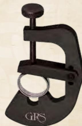
Questa morsa unica nel suo genere per il fissaggio di anelli permette la facile lavorazione della loro parte interna. Può essere tenuta in mano oppure fissata in qualsiasi morsa sferica e a vite. Realizzata in acciaio solido per una lunga durata.
