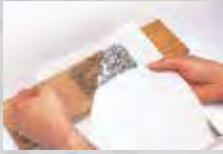
Fotocopiate il vostro disegno su questa pellicola autoadesiva in plastica (216 x 279 mm) e incoltela sul pezzo da lavorare. A questo punto basta incidere lungo le linee della pellicola.
