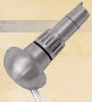
Questo è il manipolo più preciso per l'esecuzione sicura di lavori di incastonatura e incisione ultra raffinati, soprattutto in stile bulino e banconota. Il manipolo Monarch è realizzato con pomello in alluminio anodizzato e bloccapinza in acciaio inox trattato a caldo con sistema di regolazione dell'attacco per il tubo flessibile laterale.
