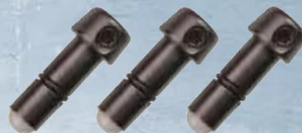
Per variare la forza di percussione dei manipoli GRS è sufficiente introdurre l'utensile o il bulino in questa nuova pinza portabulini QC con ammortizzatore. Grazie allo speciale cappuccio in materiale sintetico presente all'estremità della pinza portabulini QC, l'energia del manipolo viene trasmessa più dolcemente all'utensile, rendendo il colpo più delicato.
